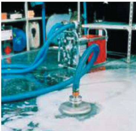
化学工場で漏洩した薬品の回収
